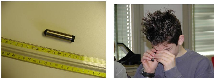
Figura 7.2.3 Spettroscopio tascabile e suo uso
