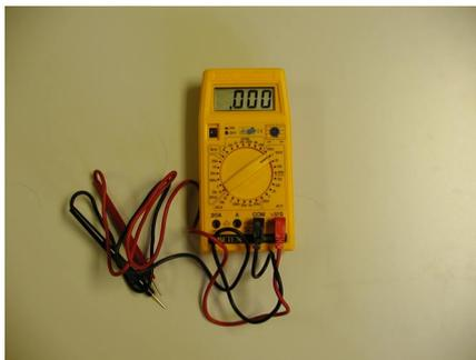
Figura 7.1.3- Multimetro digitale (con uscita numerica).
