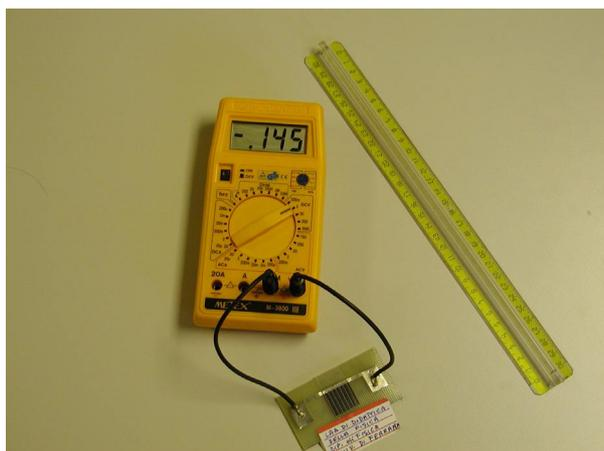
Figura7.1.1- Voltmetro e sensore collegati.
