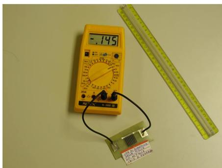
Figura 7.1.4- Il multimetro usato come voltmetro e collegato al sensore di luce.
