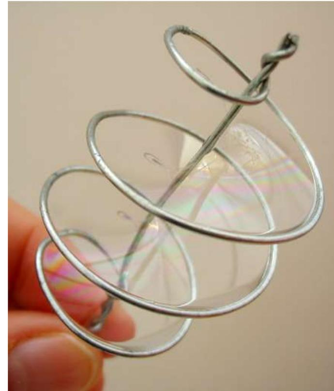
**Elicoide:** ottenuta ruotando una retta attorno ad un asse a lei perpendicolare e traslandola contemporaneamente lungo l'asse. Scoperta da **nel 1776 Meusnier**.
