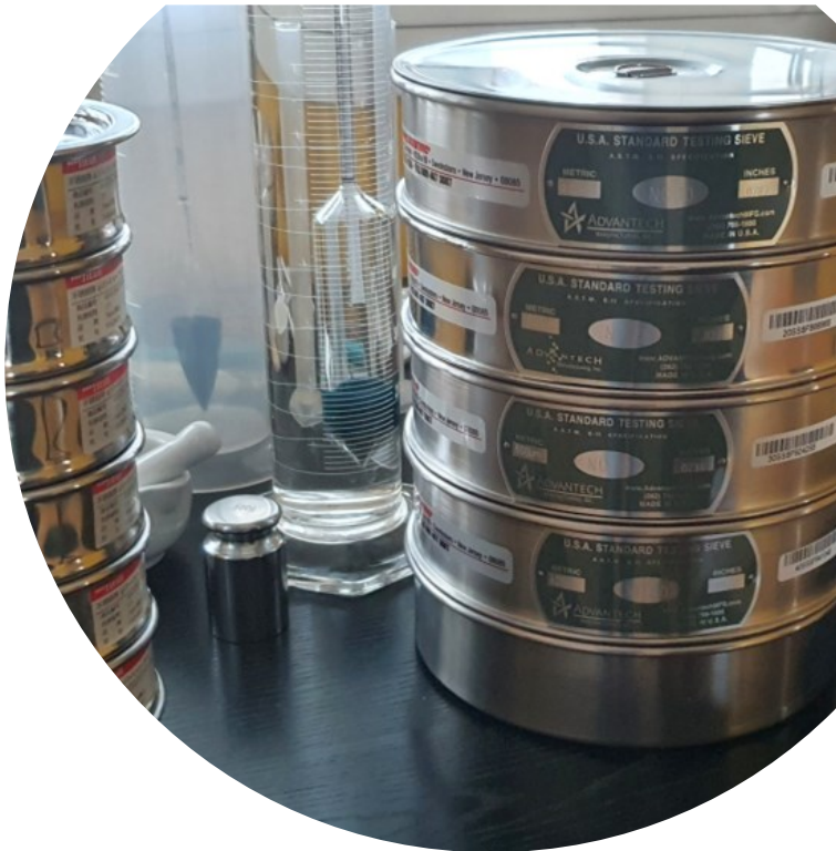
Setacci e idrometri per la costruzione delle curve granulometriche
